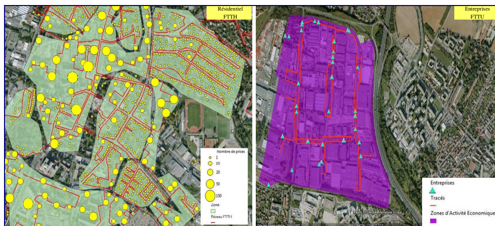
Cette méthode permet de calculer les coûts d'infrastructures entre le SRO et le PBO (Point de Branchement)
